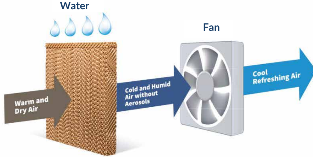
الصورة ١: التبريد التبخيري في أنظمة التبريد بواسطة ألواح التبريد
